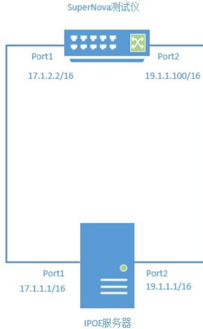
拓扑图 2 注： Supernova 测试仪的 port1(DHCP/UDP 客户端, 17.1.2.2/16)IPOE 服务器获取地址。 Supernova 测试仪的 port1(DHCP/UDP 客户端, 17.1.2.2/16) Router port1(17.1.1.1/16)port2 (19.1.1.1/16)UDP 服务器端口 port2 (19.1.1.100/16)。
